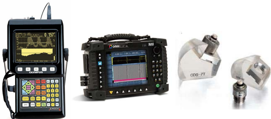
Obr. 6. Technika použitá pri skúšaní technikou 30-70-70, EPOCH 4, OmniScan a príslušenstvo
